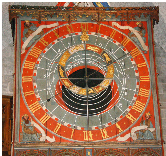
Obr. 24: Podoba zrestaurované astrolábové desky orloje v Lundu (1425). Na rozdíl od astrolábové desky Pražského orloje zde, stejně jako u mnoha severovýchodních orlojů, probíhá obzor přes vnitřní středový kruh obratníku Kozoroha. Uprostřed astrolábu uvnitř kruhu o nejmenším průměru (foto https://commons.wikimedia.org/wiki/File:Lund_astron_uhr_032.JPG ).
