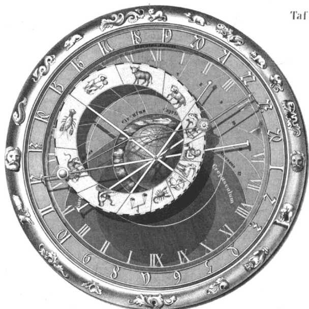
Obr. 23: Kresebný návrh podoby orloje, v originále snad barevný (Böhm 1866). Konstrukce kružnic zde teoreticky odpovídá nesprávnému sklonu zemské osy k rovině ekliptiky 25,5 0 namísto správné hodnoty 23,5 0, stejně jako na astrolábové desce Pražského orloje. Ostře ohraničený kruh temné noci, který zde neodpovídá konstrukci noci astronomické, byl patrně ovlivněn podobami astrolábových desek některých severských orlojů v Lundu (Švédsko) a Doberanu (Německo).
