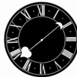
Obr. 1. Schéma ciferníku s jedinou ručkou hodinovou. Ručka má vždy rameno s protizávažím. V mezerách mezi ciframi jsou půlhodinové značky.
