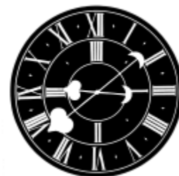
Obr. 2. Schéma ciferníku s vnitřním minutovým ciferníkem a malou minutovou ručkou
